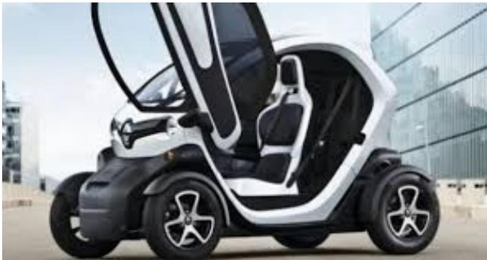
**Renault Twizy** est une petite voiture électrique (éco mobilité), de la série Renault Z.E., commercialisée en deux catégories de puissance (voiture sans permis bridée à 45 km/h et voiture avec permis B la vitesse est alors augmentée à 80 km/h) par le constructeur automobile Renault depuis 2011 (16 331 modèles ont été vendus en 5 ans<sup>1</sup> aux environs de 7000 à 9000 €).
